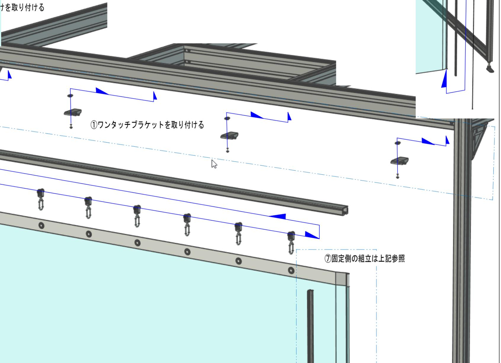
②レールにランナーを挿入しワンタッチブラケットに押し付け固定する
